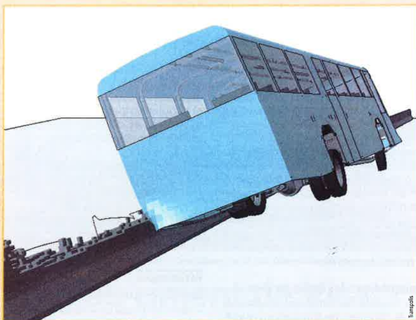
Figure 3 Simulation d'un véhicule lourd de type car sur une DBA.
