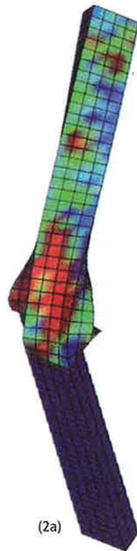
Figure 2 Exemples d'outils d'analyse par simulation du comportement d'un dispositif de retenue. A l'aide de simulations numériques, il est possible de visualiser de manière réaliste les essais de choc, mais surtout d'analyser en détail les mesures physiques (courbes) comme les répartitions de contraintes dans les éléments constituant le dispositif.
